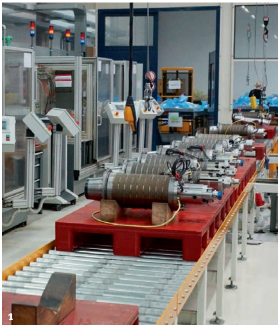
1 Pro Tag werden bei Kessler rund 60 bis 80 Motorspindeln gefertigt und geprüft. 2 In der Regel dauert ein Prüfzyklus etwa fünf bis sechs Stunden, Prototypen werden aber auch schon mal 1 000 Stunden getestet. 3 Jede Spindel wird individuell auf die Bedürfnisse des jeweiligen Kunden hin entwickelt, gefertigt und geprüft.
