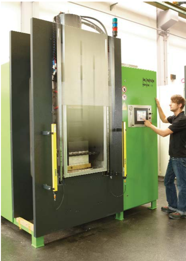
Bild 2: Grinding Wheel Sinter Press GSP230
