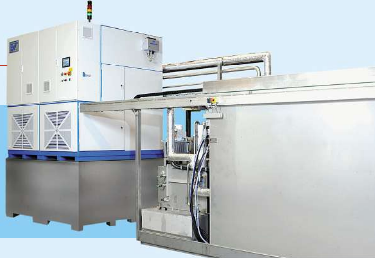
Die Entfettungsanlagen sind hochkomplexe Anlagen, die eine hohe Maschinenverfügbarkeit aufweisen müssen. Dank Fernwartung ist dies möglich.
