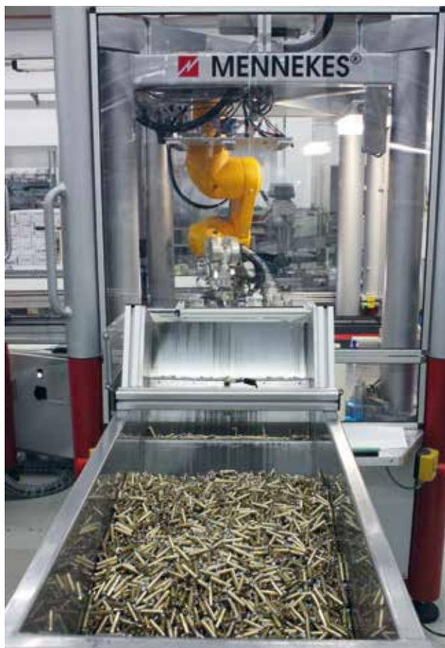
**Bild 2.** Auch die Sondermaschinen in der Großserienfertigung, zum Beispiel zur Montage von Steckkontakten und Kunststoffteilen, sollten an das MES angebunden werden
